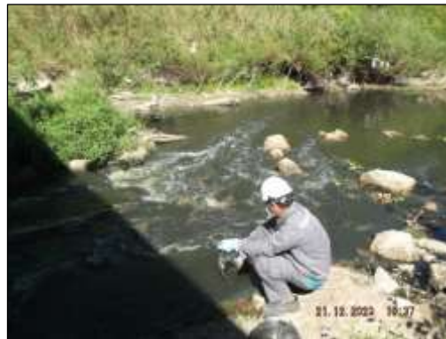
รูปที่ 3.14 การเก็บตัวอย่างแหล่งน้ำผิวดิน บริเวณคลองใหญ่ บริเวณท้ายจุดระบายน้ำทั้งจากโครงการ ระยะห่าง 1,000 เมตร (SW5)
