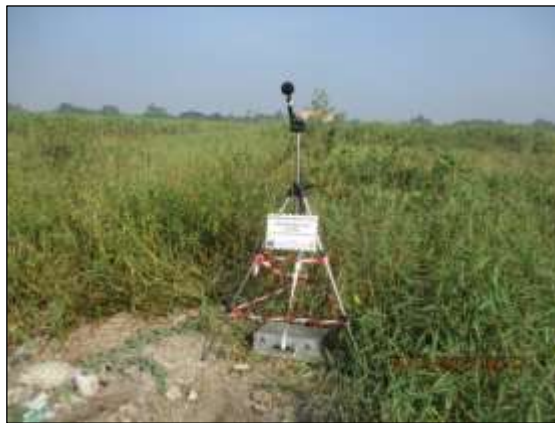
รูปที่ 3.9 ตรวจวัดระดับเสียงจากกิจกรรมก่อสร้างจากการใช้เครื่องจักรประเภทต่างๆ
