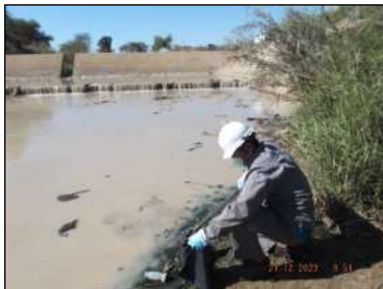
รูปที่ 3.26 การเก็บตัวอย่างตะกอนดิน บริเวณคลองใหญ่ บริเวณจุดระบายน้ำทิ้งของโครงการ ระยะห่าง 1,000 เมตร (SD3)
