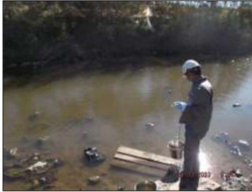
รูปที่ 3.10 การเก็บตัวอย่างตัวอย่างแหล่งน้ำผิวดิน บริเวณคลองใหญ่ก่อนไหลผ่านพื้นที่โครงการ ก่อนจุดระบายน้ำทิ้งของโครงการระยะห่าง 1,000 เมตร (SW1)
