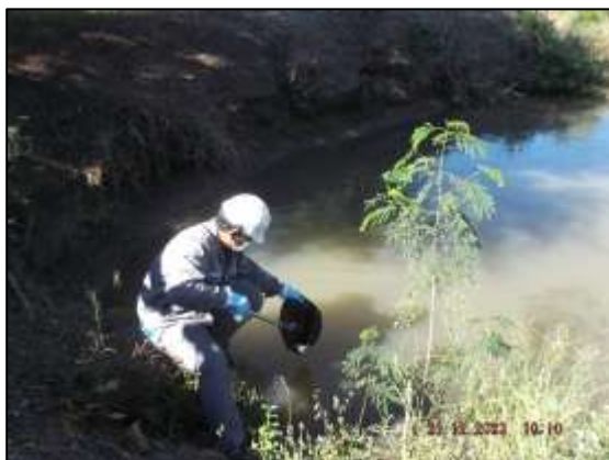
รูปที่ 3.29 การเก็บตัวอย่างแหล่งน้ำผิวดิน บริเวณคลองป่าแดง บริเวณด้านทิศเหนือของโครงการ ระยะห่าง 500 เมตร (SD6)
