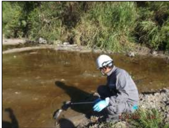
รูปที่ 3.25 การเก็บตัวอย่างตัวอย่างตะกอนดิน บริเวณคลองลำปางก่อนไหลผ่านพื้นที่โครงการ ก่อนจุดระบายน้ำทิ้งของโครงการระยะห่าง 1,000 เมตร (SD2)
