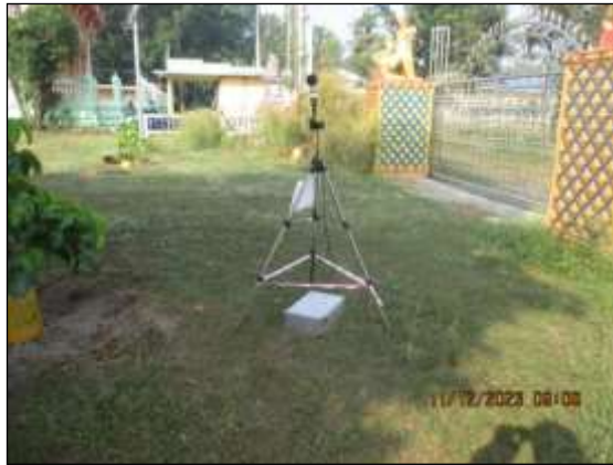
รูปที่ 3.8 การตรวจวัดระดับเสียงโดยทั่วไป บริเวณวัดอ่างเวียน (N4)
