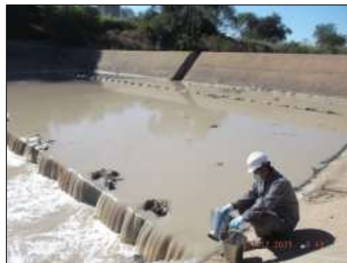
รูปที่ 3.12 การเก็บตัวอย่างแหล่งน้ำผิวดิน บริเวณคลองใหญ่ บริเวณจุดระบายน้ำทิ้งของโครงการ ระยะห่าง 1,000 เมตร (SW3)
