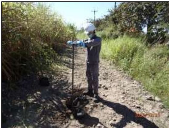
รูปที่ 3.21 การเก็บตัวอย่างวิเคราะห์คุณภาพดิน บริเวณพื้นที่สีเขียวด้านทิศตะวันตก (S2)
