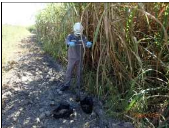
รูปที่ 3.22 การเก็บตัวอย่างวิเคราะห์คุณภาพดิน บริเวณพื้นที่สีเขียวด้านทิศเหนือ (S3)
