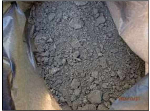
รูปที่ 3.23 การเก็บตัวอย่างวิเคราะห์คุณภาพดิน บริเวณพื้นที่สีเขียวด้านทิศใต้ (S4)
