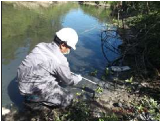
รูปที่ 3.28 การเก็บตัวอย่างแหล่งน้ำผิวดิน บริเวณคลองใหญ่ บริเวณท้ายจุดระบายน้ำทิ้งจากโครงการ ระยะห่าง 1,000 เมตร (SD5)
