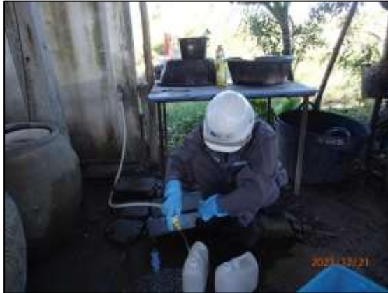
รูปที่ 3.16 การเก็บตัวอย่างตัวอย่างแหล่งน้ำใต้ดิน บริเวณบ้านเขาไฟ (GW1)
